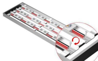
通过螺丝锁紧，将装好模组的型材固
